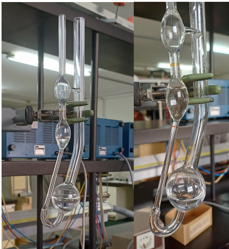
Imágenes 3 y 4, Viscosímetro en funcionamiento
